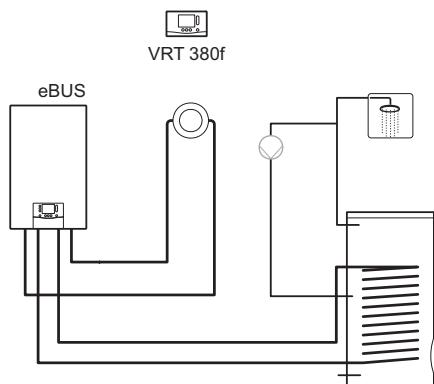
Регулятор вбудовують у прості системи з прямим опалювальним контуром.
